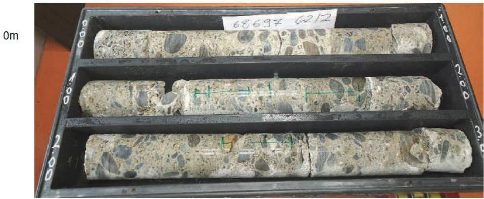
Bohrkerne aus dem Galleriemauerwerk Carote estratte dalle gallerie
