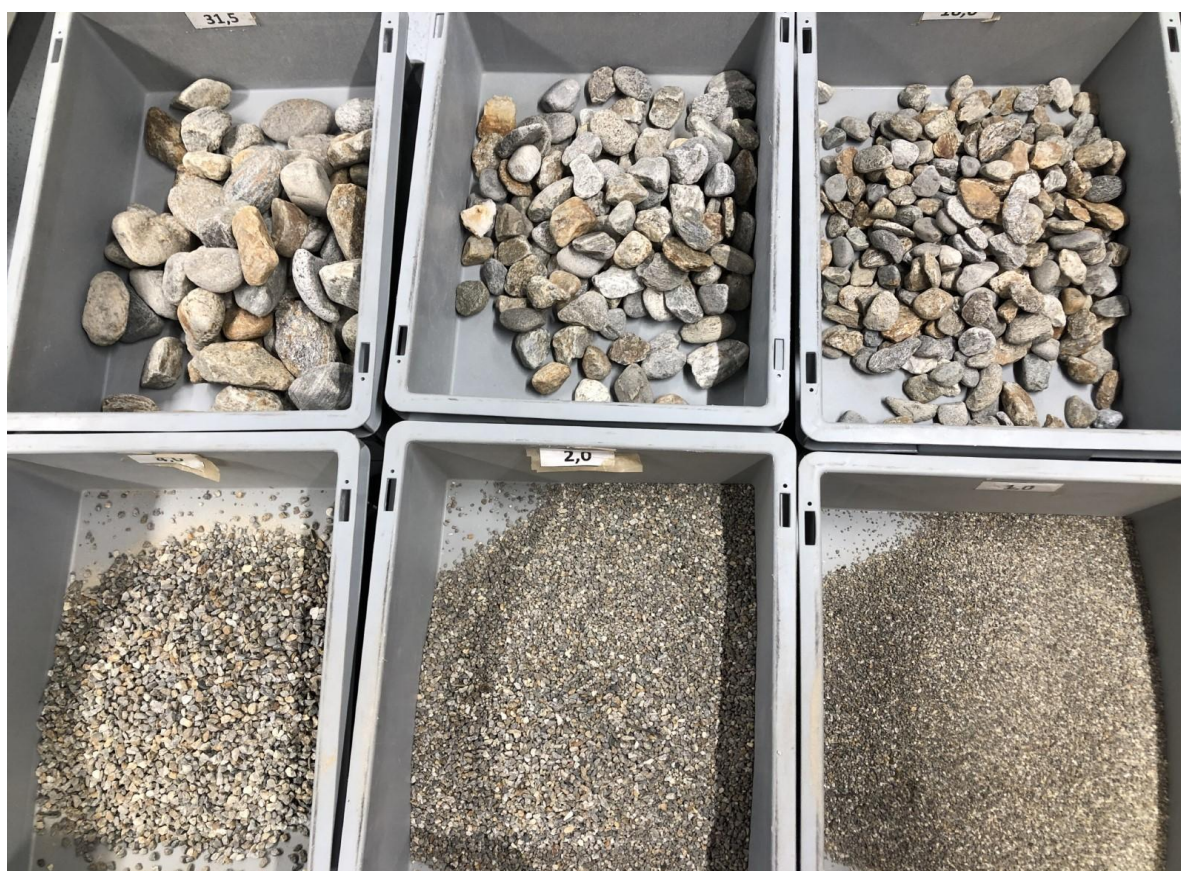
Figura 13. Esempi di frazioni di sedimento trattenute dopo la setacciatura meccanica.
