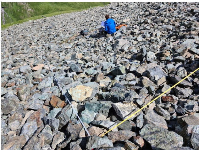
Abbildung 1. Aufgelegtes Messnetz innerhalb von Modelbereich 3.
