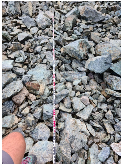
Abbildung 8. Foto im Bereich des Modellbereichs 1. Homogenes Korngemisch.
