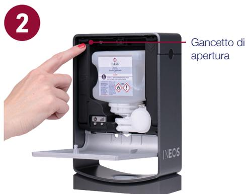
Spingere verso il basso il gancetto per aprire la custodia della batteria. Utilizzare solo una batteria ricaricabile ai polimeri di litio, modello IP704282.
