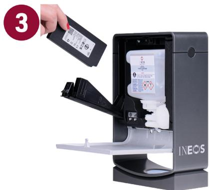
Inserire la batteria nella custodia con l'etichetta della batteria rivolta verso l'interno del dispenser. Quindi chiudere la levetta della batteria finché il gancetto non scatta in posizione.
