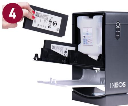
Insérez la batterie de rechange (achetée séparément) dans le logement prévu à cet effet, à droite, comme indiqué dans l'étape 3.
