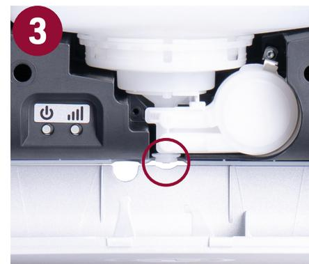
Une petite quantité de gel séché peut se trouver autour de la sortie du distributeur ou de la cartouche. Si c'est le cas, nettoyez à l'intérieur et autour de la sortie pour le retirer.
