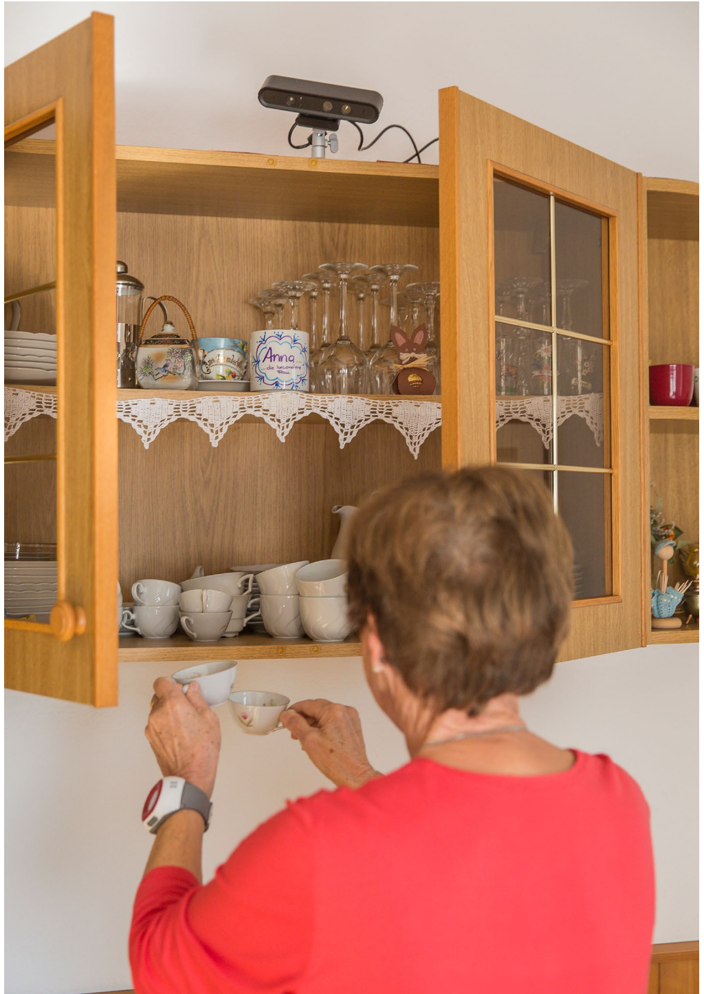
Unauffällig und doch von großer Bedeutung: Der 3D-Sturzsensor (schwarzer Gegenstand, oberhalb Schrank) wird aktiviert, wenn sich eine Person für einen längeren Zeitraum nicht vom Boden wegbewegt.
