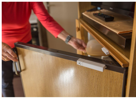
Der Sensor am Kühlschrank meldet dem Smart Home System, ob die Schranktür geöffnet wurde – oder nicht. Wenn nicht, folgt eine Reihe von vordefinierten Schritten, um sicherzustellen, dass es dem Betroffenen gut geht.
