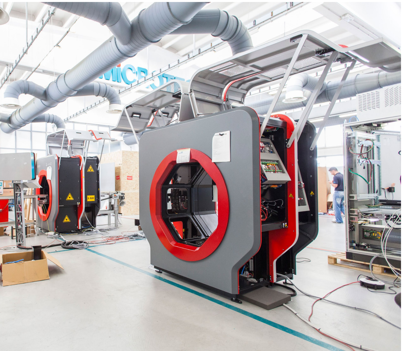
Alla Microtec si producono scanner biometrici capaci di indagare in profondità le caratteristiche di legno e frutta
