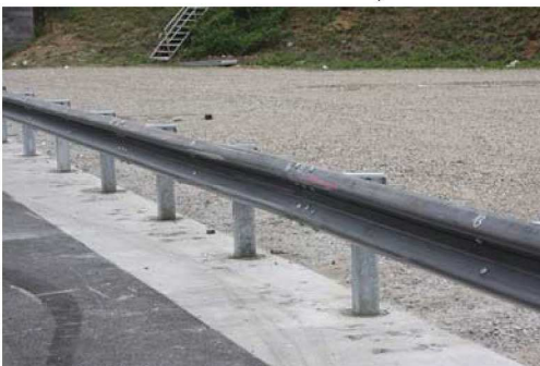
↓ ↑ Deuxième choc (lisses n°13 et 14) / Second impact (W-beams nrs. 13 and 14) / Secondo urto (nastri n°13 e 14) ↓
