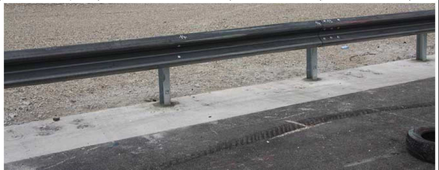
↓ ↑ Deuxième choc (lisses n°13 et 14) / Second impact (W-beams nrs. 13 and 14) / Secondo urto (nastri n°13 e 14) ↓
