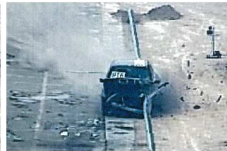
Plasticizzazione alla base dei montanti infissi PAB N2 T2 senza sfilamento
