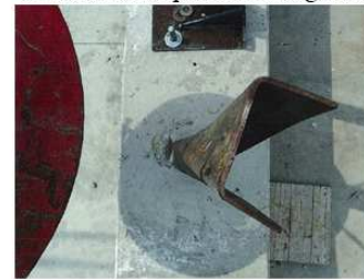
Deformazione paletto H2 inghisato
