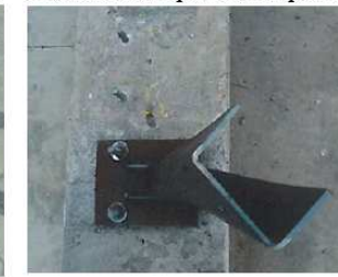
Deformazione paletto H2 piastrato
