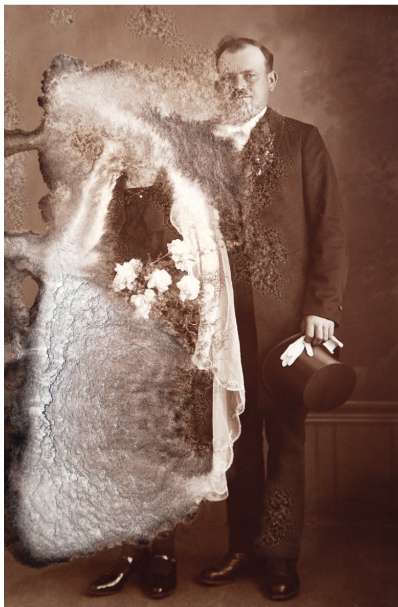
Abb. 2 Gelatinesilber- abzug, 14,7 × 10,3 cm, Fotografin/Foto- graf unbekannt, Schichtverände- rung durch Wärme
