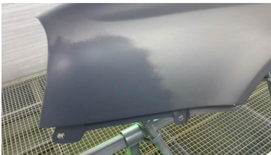
zur Lackierung vorbereitete Füllerstelle
