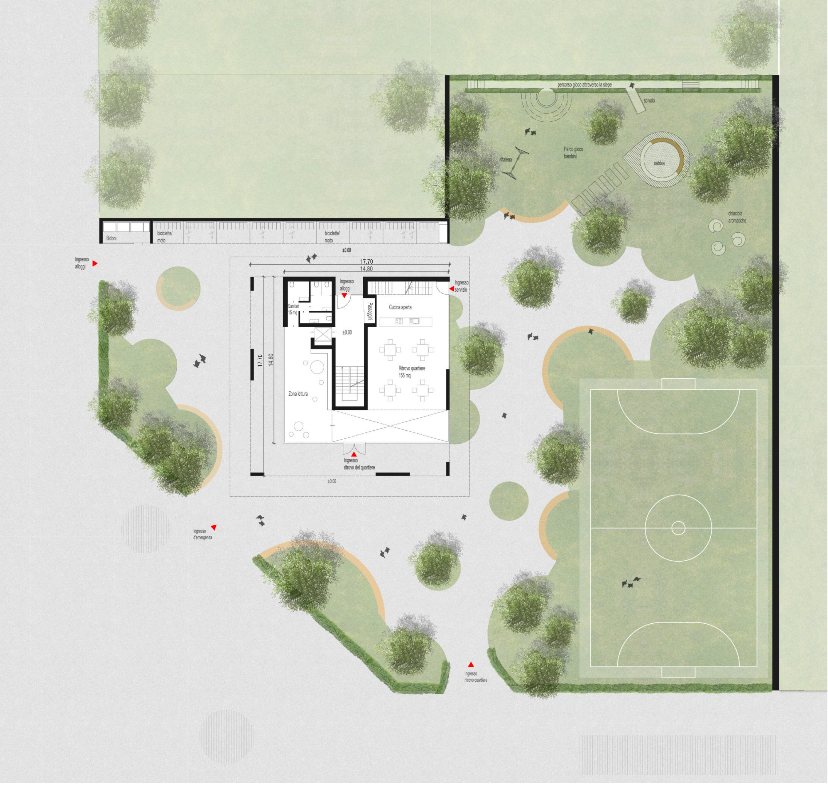
PIANTA PIANO TERRA CON SISTEMAZIONE ESTERNA 1/200
