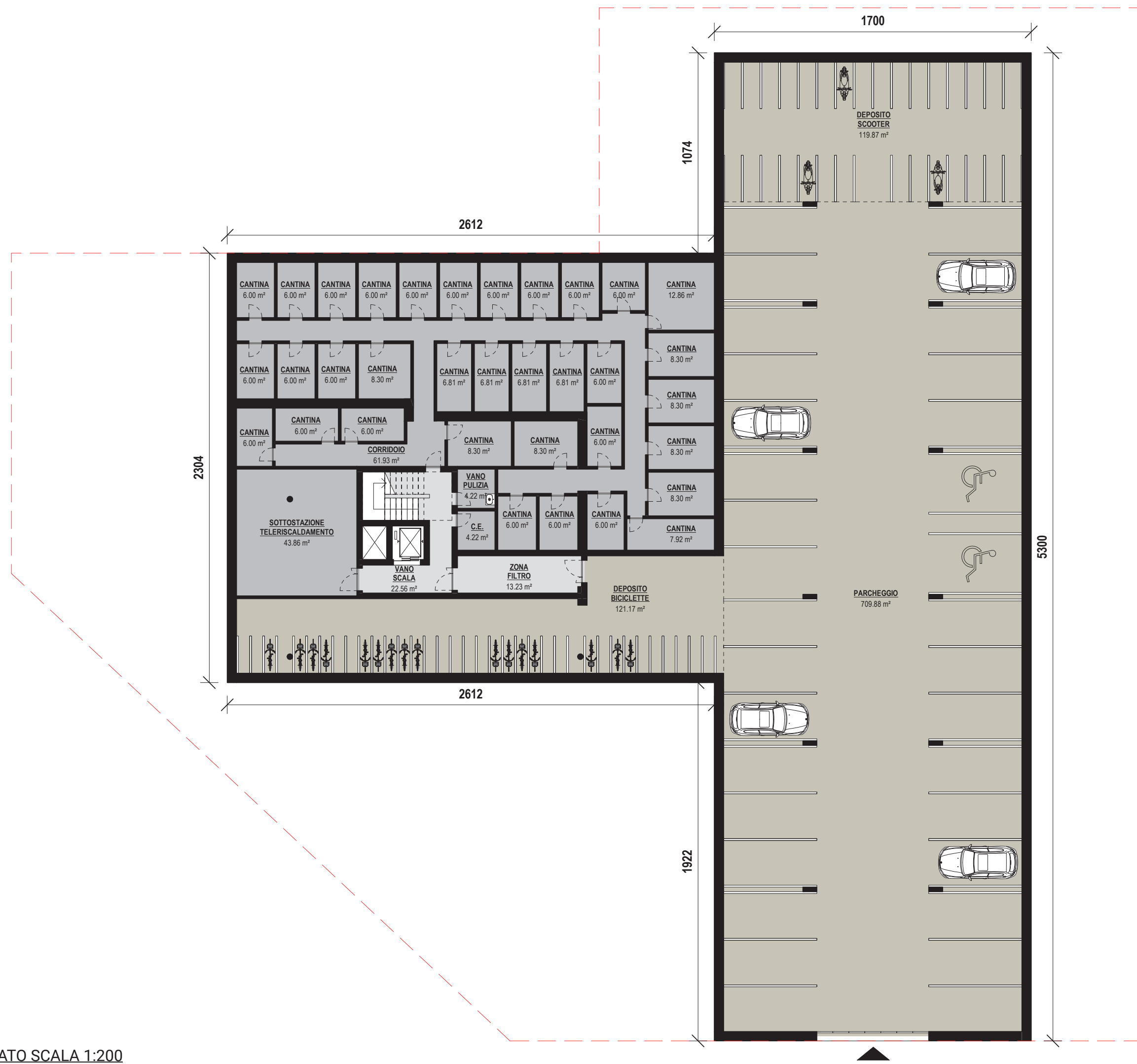
PIANO INTERRATO SCALA 1:200
