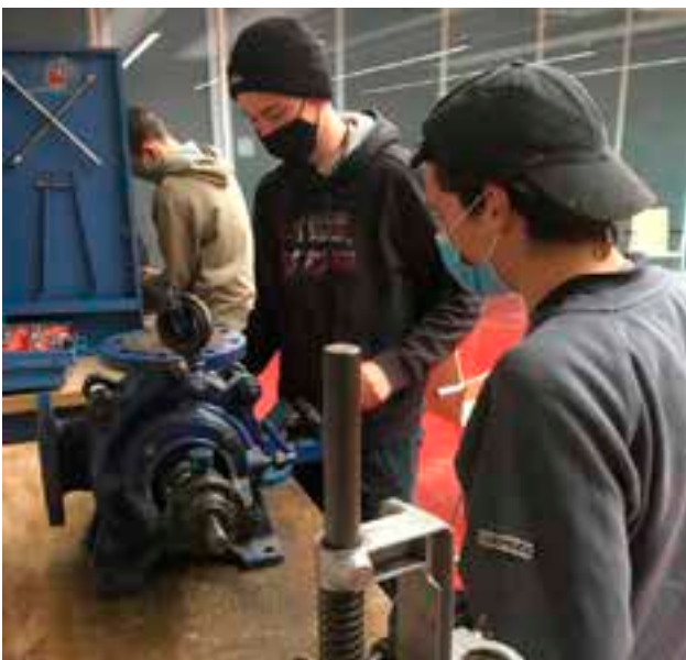
Wartung Beregnungspumpen. Zerlegung, Wartung, Erklärung und wieder erneuerter Zusammenbau der verschiedenen Beregnungspumpen. Praxis Landtechnik in der Ausbildung Obst- und Weinbau.
