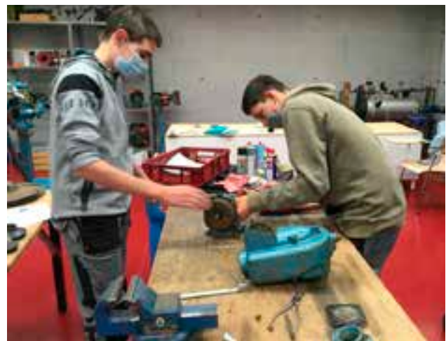
Wartung Beregnungspumpen. Zerlegung, Wartung, Erklärung und wieder erneuerter Zusammenbau der verschiedenen Beregnungspumpen. Praxis Landtechnik in der Ausbildung Obst- und Weinbau.
