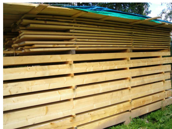
Abb. 3: Abdecken des Schnittholzes
