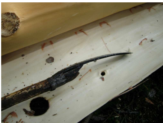
Abb. 2: „Schleissen“ des Rundholzes mit dem „Schleisseisen“
