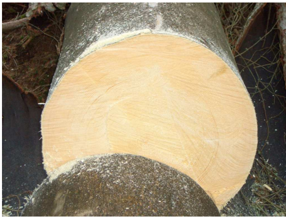
Abb. 5: fehlerfreies Sägerundholz (Schlägerungstag 21. Juni, Stamm mit Wipfel, Foto bei Ablängung im August)
