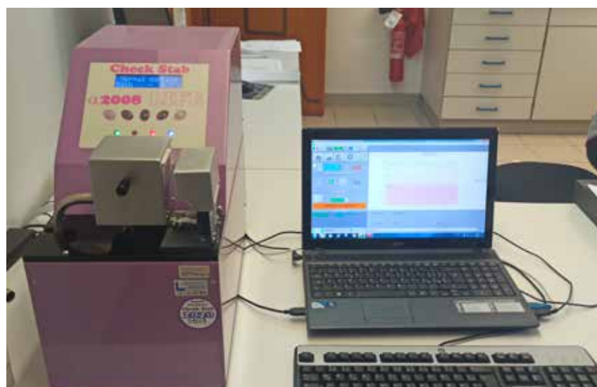
Abb. 4: Checkstab α2000 Life, Laborgerät zur Messung der Änderung der elektrischen Leitfähigkeit.
