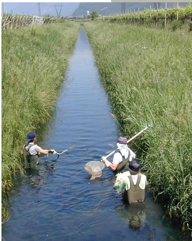
Fig. 11.8: I monitoraggi con elettropesca forniscono informazioni sulla condizione ittologica delle acque.
