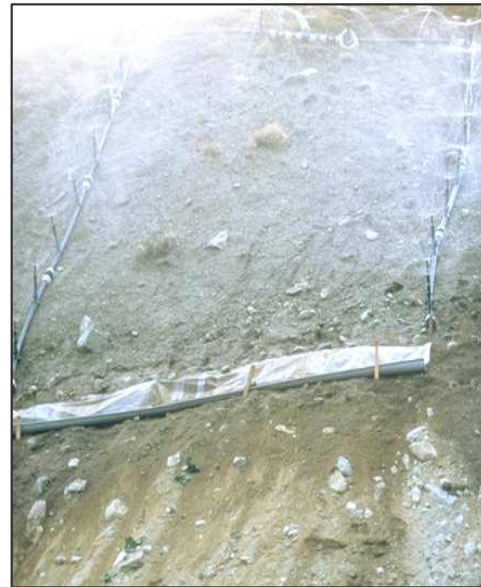
Splash Erosion Effekt, beginnende lineare Erosion nach 10 min
