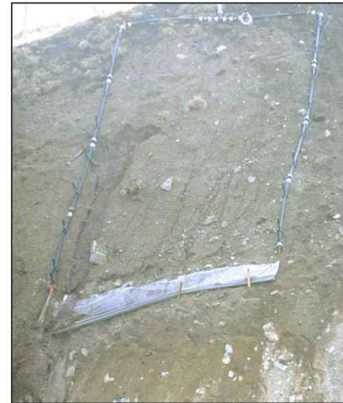
Lineare Erosion mit Hangmure \psi_{\text{const}} = 0,1 Abbruch nach 31 min
