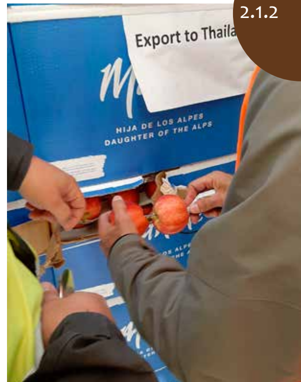
Im Container: Platzierung der Temperatursonde für den Apfelexport nach Thailand
