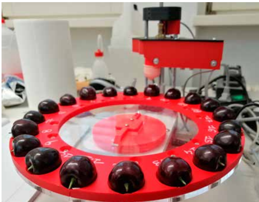
Abb. 4: Das Messinstrument Agrostawood® ermöglicht eine automatische und präzise Messung der Fruchtfestigkeit. Die Messskala reicht von 0 (sehr weich) bis 100 (sehr fest) und wird „Durofel-Index“ genannt.
