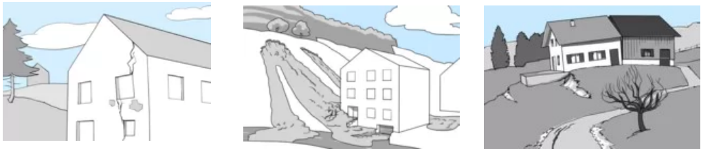
Auswirkungen und mögliche Schäden von mittel- bis tiefgründigen Rutschungen in Abhängigkeit von der Geschwindigkeit
