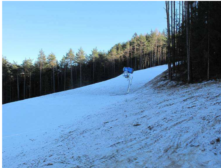
7.2 Schneekanone – Cannone da neve
