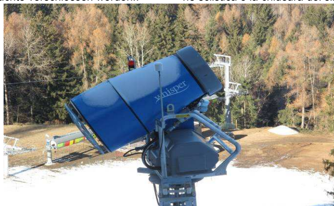
7.3 Schneekanone - Cannone da neve
