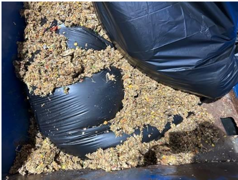
Grigliato estratto presso il depuratore di Pontives
