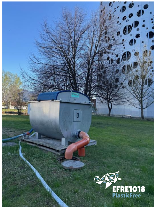
Filtro mobile con maglia di 10 micron
