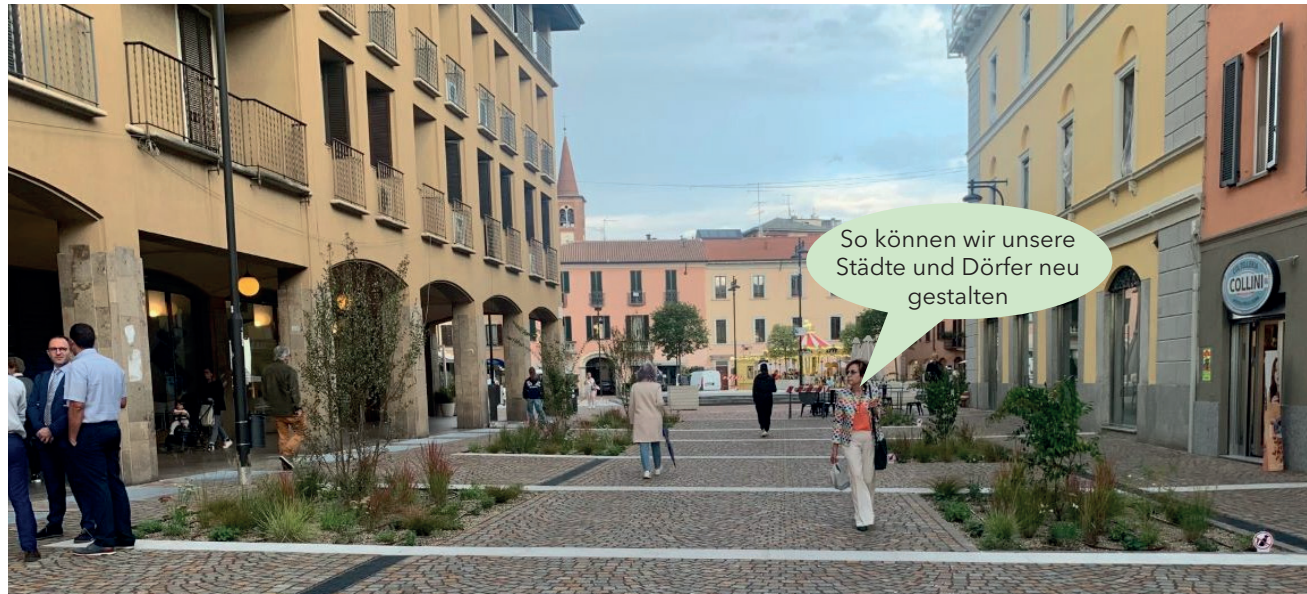
Busto Arsizio: Der asphaltierte Straßenabschnitt mit vielen Parkplätzen und schmalen Fußgängerwegen wurde in eine Fußgängerzone umgeplant. Wasserdurchlässige Beläge und eine ansprechende Begrünung kombiniert mit Versickerungsmulden tragen zur Aufwertung der Aufenthaltsqualität im Ortszentrum bei. Foto: Olivia Rabbi.
