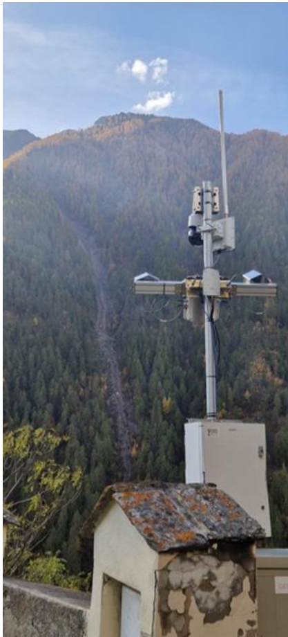
Abb. 5.13: Monitoringsystem mittels Doppler-Radar und Überwachungskameras (links und rechts oben im Bild) und automatische Ampelregelung auf der LS. 3 (rechts unten im Bild).
