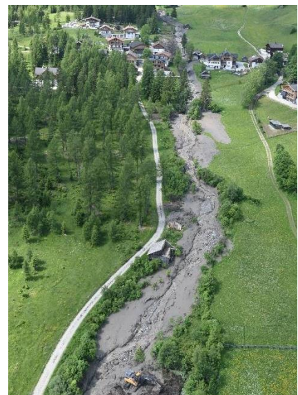
Abb. 4.10: Der Erdrutsch wurde knapp unterhalb der Wasserscheide infolge der raschen Schneeschmelze und der Regenfälle ausgelöst. Durch den Wasserzufluss aus dem Einzugsgebiet des Seresbaches entwickelte sich die Rutschung in eine Mure, die das Dorf Campill und den Kampillerbach erreichte.
