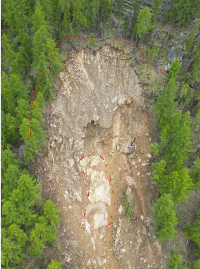
Abb. 5.11: Anbruchnisse des Glograbens mit freigelegter ENE-WSW verlaufender Großkluft in Bildmitte (linkes Bild) und Anbruchnisse des Stallelegrabens im stark zerlegten Felsverband (rechtes Bild).
