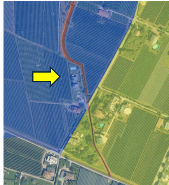
Abb. 4.8: Der Talboden der Etsch (Adige) ist durch ausgedehnte Gefahrenzonen mittlerer und hoher Gefährdung gekennzeichnet, die oft mit häufigen, aber schwach ausgeprägten Überschwemmungen von Gräben und kleinen Bächen verbunden sind. Diese Situationen können durch Maßnahmen bewältigt werden, die den Abfluss erleichtern, aber auch durch einfache Maßnahmen zur Verringerung der Schadensanfälligkeit.
