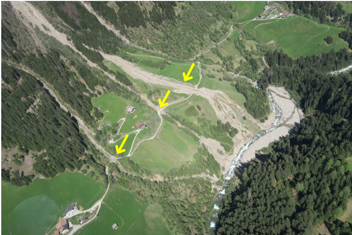
Abb. 5.19: Ablagerungsbereich der Felsstürze mit dem Weiler Geraine orographisch links des Mareiterbachs. Die großen Mengen an Sturzschutt in den morphologischen Kanälen und die hohe Wassersättigung infolge der Niederschläge führte zu sekundären Murgängen (gelbe Pfeile).
