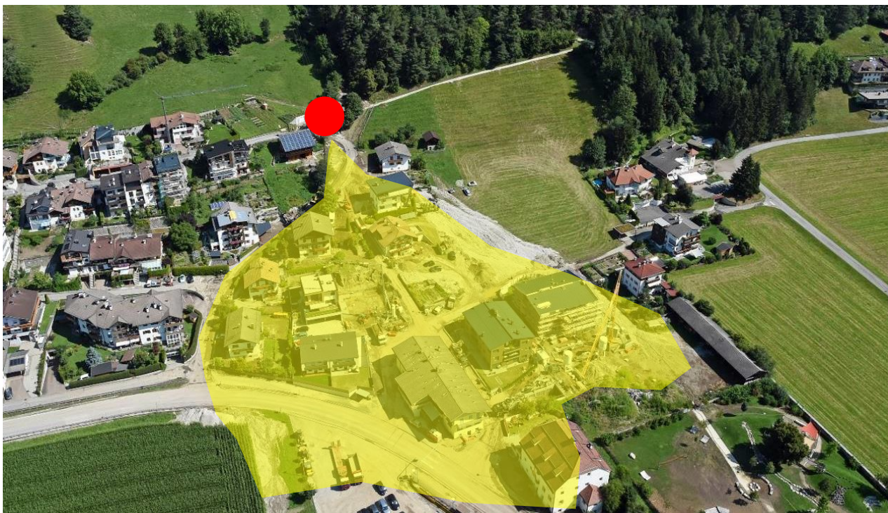
Figura 17: Foto da elicottero della frazione di Vandoies di Sopra: il punto rosso indica il tombone occluso, l'area in giallo la zona colpita dalla colata detritica. Le scarse portate ordinarie del fossato Horner vengono smaltite da un tombone sotterraneo che attraversa il paese
