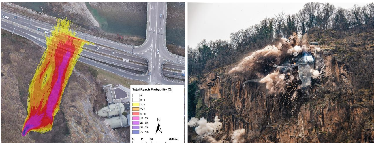
Figura 36: a sx simulazioni di caduta massi in 3D realizzate per determinare le possibili traiettorie dei blocchi di caduta e la portata, e per fare le corrispondenti misure organizzative e preparatorie. A dx un'immagine del brillamento del 10 febbraio 2020
