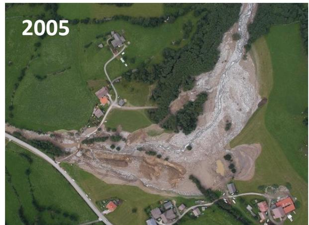
*Abb 4.10: Das zwischen 2006 und 2007 von der Wildbachverbauung errichtete Rückhaltebecken wurde mit ca. 15.000-20.000 m<sup>3</sup> Geschiebe aufgefüllt. Im Jahr 2005 hatten zwei aufeinanderfolgende Ereignisse ca. 130.000 m<sup>3</sup> Geschiebe in Richtung Tal transportiert (Foto rechts).*
