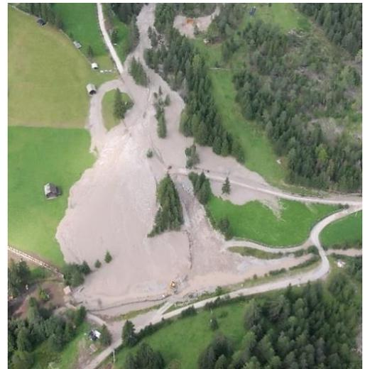
*Abb. 4.16: Das Ereignis des Bronsarabaches führte etwa 45.000-60.000 m<sup>3</sup> Schutt flussabwärts. Dabei handelte es sich um ein deutlich größeres Volumen als bei den vorherigen Ereignissen (rechtes Bild: Aufnahme des Murganges von 2012).*
