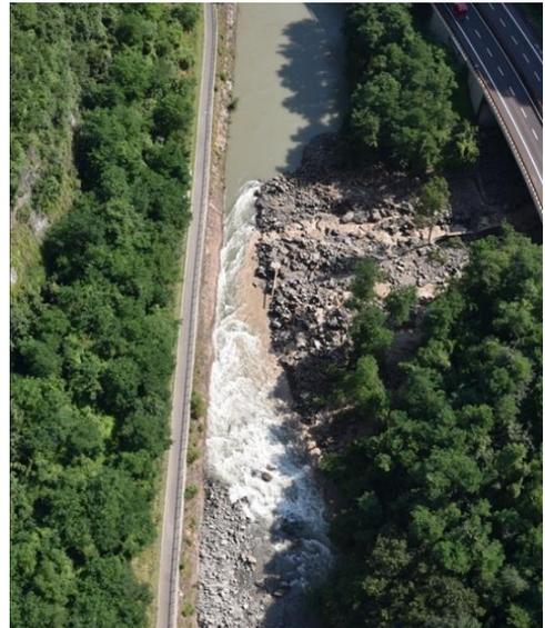
Figura 4.13: in alto il punto in cui il Rio Nero è esondato in sinistra (freccia gialla) alluvionando alcune ditte nella zona artigianale (dettaglio in alto a destra); dopo aver depositato parte dei detriti, la piena ha ripreso ad erodere le sponde e l'alveo In basso a destra i detriti del Rio Nero (ca 40.000 m<sup>3</sup>) che restringono localmente la sezione dell'Isarco
