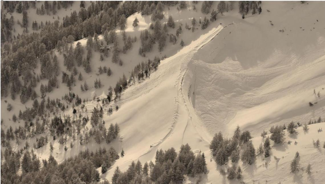
Figura 6.13: Per effetto delle temperature molto basse di inizio anno, una valanga polverosa si è staccata dalle pendici della Croda Bianca, andando a traboccare dalla diga di contenimento alta 18m e depositandosi per un tratto di 200m.
