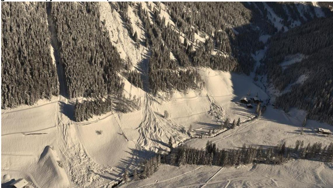
Figura 6.11: Diverse valanghe miste hanno invaso, per circa 250m, la strada comunale che porta ai masi Vannes. Il maso Gruber, in basso a sinistra nella foto, è stato protetto da un argine paravalanghe lungo 80 m.
