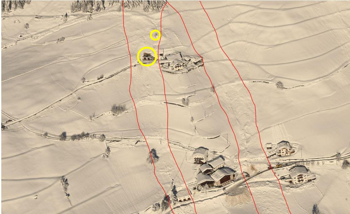
Figura 6.12: Nei pressi del maso Braitia, nel comune di Martello, un vecchio mulino ed una stalla sono stati distrutti dalla massa di neve della valanga (cerchi gialli).
