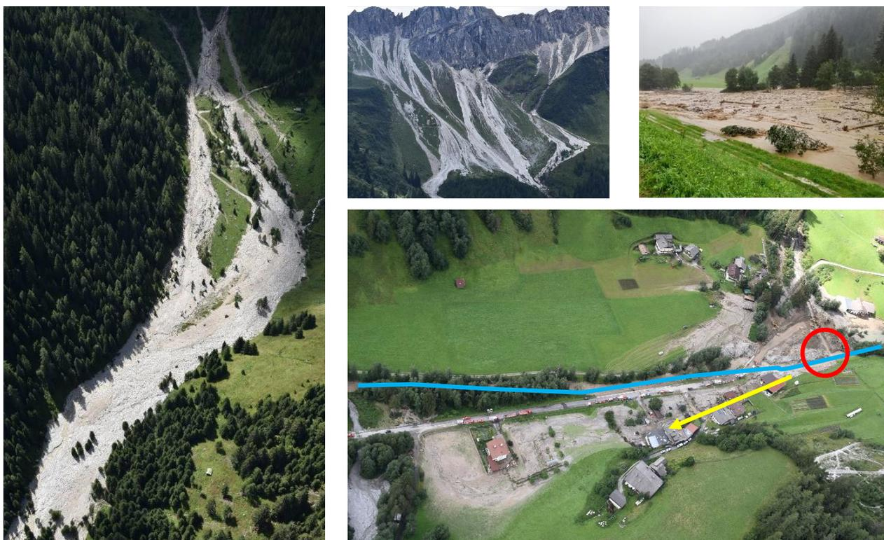
Figura 4.25: a sinistra: l'estesa area di deposito di detriti (ca. 25.000 – 35.000 m<sup>3</sup>) di tipo dolomitico; in alto al centro: le falde detritiche alla testata del bacino; in alto a destra: il deposito alla confluenza che ha occluso il Rio di Fleres; in basso a destra: l'area alluvionata dal Rio Fleres (linea gialla) in sinistra orografica, proprio in seguito all'occlusione provocata dal Rio di Toverino (punto rosso)
