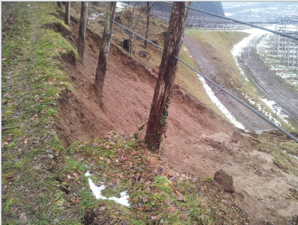
Superficie di scorrimento piano-parallela
