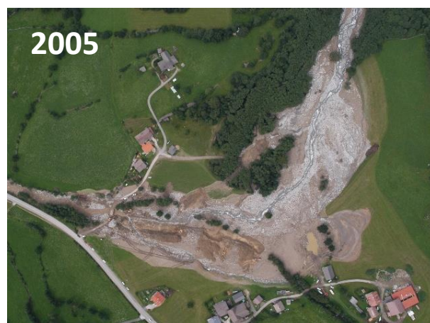
Figura 4.10: La briglia di trattenuta, realizzata tra il 2006 e il 2007 dai Bacini Montani, ha invasato ca. 15.000-20.000 m 3 di detriti. Nel 2005 due eventi consecutivi avevano portato a valle ca. 130.000 mc (foto a dx)
