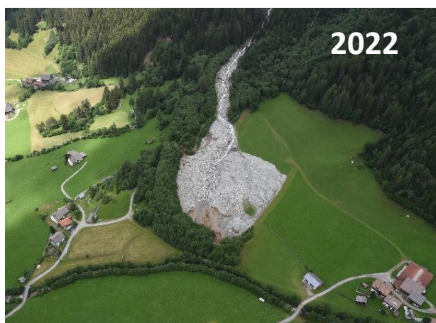
Figura 4.10: La briglia di trattenuta, realizzata tra il 2006 e il 2007 dai Bacini Montani, ha invasato ca. 15.000-20.000 m 3 di detriti. Nel 2005 due eventi consecutivi avevano portato a valle ca. 130.000 mc (foto a dx)
