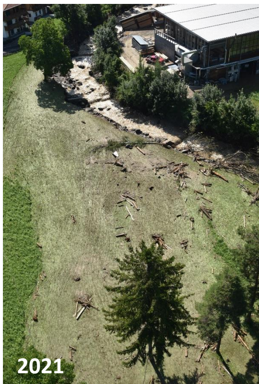
Figura 4.20: Il Rio Nero era stato colpito da un grave evento anche nel 2021. Nel 2022, seppur in maniera meno violenta, l'evento alluvionale ha provocato danni alle opere di sistemazione e diffusi fenomeni erosivi
