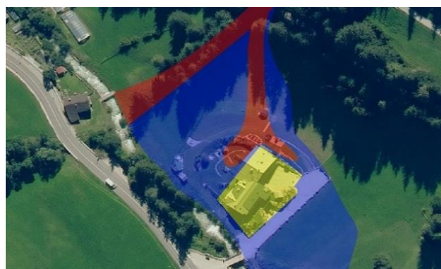
Figura 4.18: Lo scenario di occlusione del ponte sulla strada forestale (punto giallo) è stato correttamente considerato negli studi relativi al Piano delle zone di pericolo del Comune di Marebbe (foto a destra), attualmente in elaborazione, confermando l'importanza di questo strumento pianificatorio
