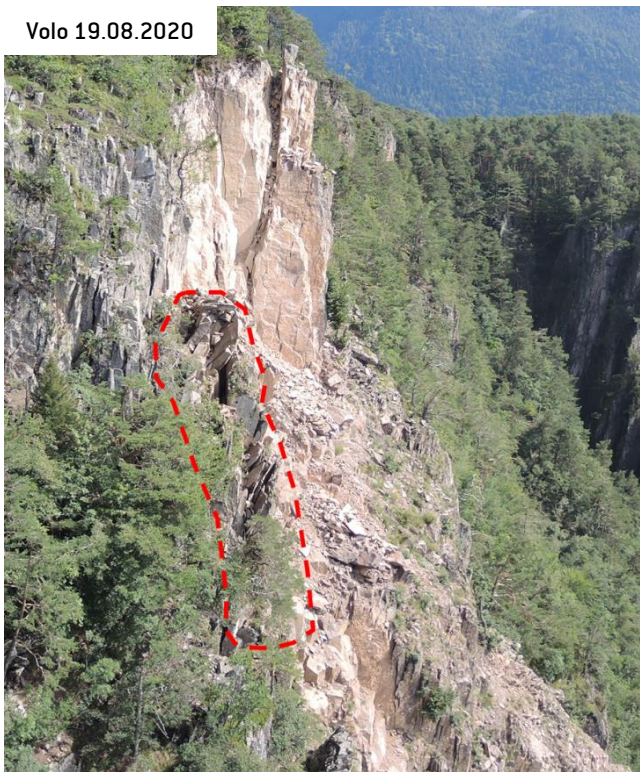
Figura 5.9. Confronto fotografico delle nicchie di crollo della caduta di massi del 2018 e del 2022, basato su diverse immagini aeree. Sia nella vista frontale che in quella laterale, è possibile delimitare molto chiaramente il volume del crollo del 15 gennaio 2022.
