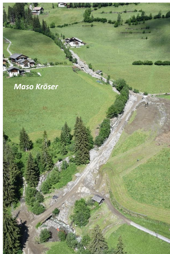
Figura 4.7: Dove l'alveo non risulta consolidato, gli eventi alluvionali possono creare estesi fenomeni erosivi. Gli alvei consolidati risultano però spesso insufficienti, soprattutto in corrispondenza degli attraversamenti, come si nota nella foto in basso a sinistra.
