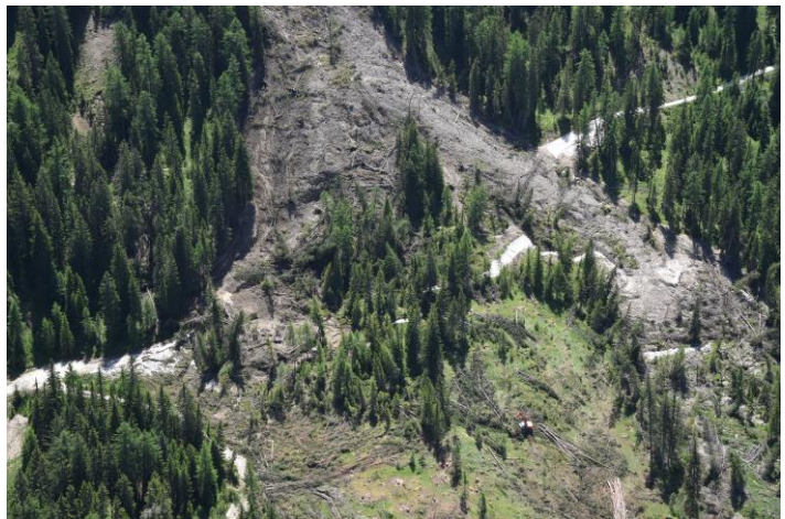
Abb. 5.13: Die massive Rutschung zerstörte die Straße nach Antersasc und Teile der darunterliegenden Straße Juel – Longiarü. Rechts im Bild die Situation nach dem Ereignis während der Aufräumarbeiten; größere Bäume wurden geschnitten und entfernt, zuvor wurde bereits die Straße Juel – Longiarü freigeräumt
