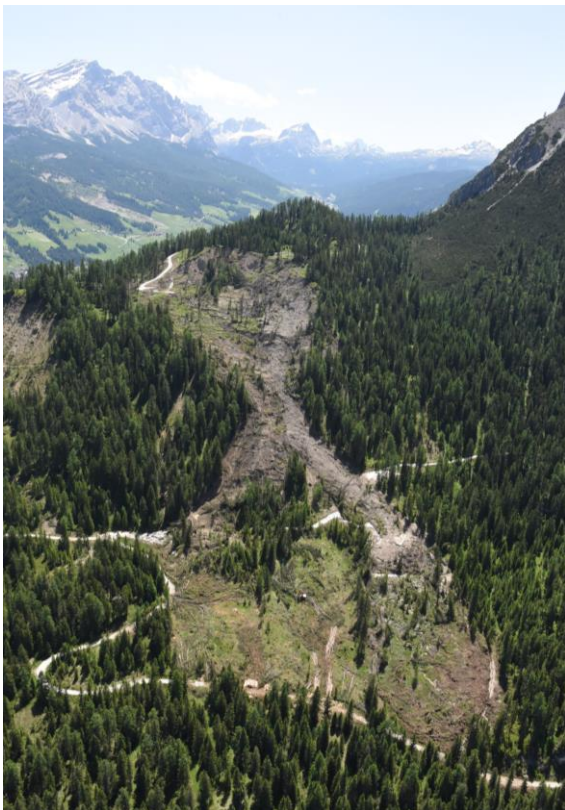
Abb. 5.13: Die massive Rutschung zerstörte die Straße nach Antersasc und Teile der darunterliegenden Straße Juel – Longiarü. Rechts im Bild die Situation nach dem Ereignis während der Aufräumarbeiten; größere Bäume wurden geschnitten und entfernt, zuvor wurde bereits die Straße Juel – Longiarü freigeräumt
