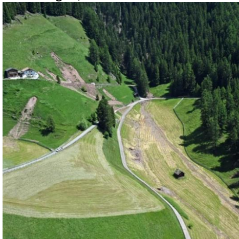
Abb. 4.7: links und Mitte: Heftige Regenfälle, begleitet von Hagel, haben zu neuen Erosionen geführt, welche die Verfügbarkeit von Schutt im Einzugsgebiet erhöhen. Solche Prozesse sind in Analysen zur hydraulischen Gefährdung eher schwierig zu bewerten. Rechts: die Reihe von Konsolidierungssperren, welche vom Amt für Wildbach- und Lawinerverbauung im zentralen Einzugsgebiet errichtet wurden, haben die Erosionsprozesse im Bachbett in Grenzen gehalten.
