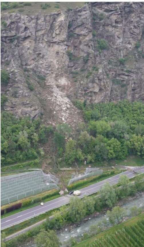
Abb. 5.8: Felssturz auf die Staatstraße 38 bei km 172+250 bis km 172+380. Luftbildaufnahme des Abbruchbereichs, der Sturzbahn und des Ablagerungsbereichs, aufgenommen am Morgen des 22. Mai; Luftbildaufnahme der Abbruchkante auf 770 m ü.d.M.; Foto des größten Sturzblocks mit einem Volumen von ca. 30 m 3 (1,9 x 4 x 4 m), der bis auf die Fahrbahn der Staatstraße 38 gestürzt ist.
