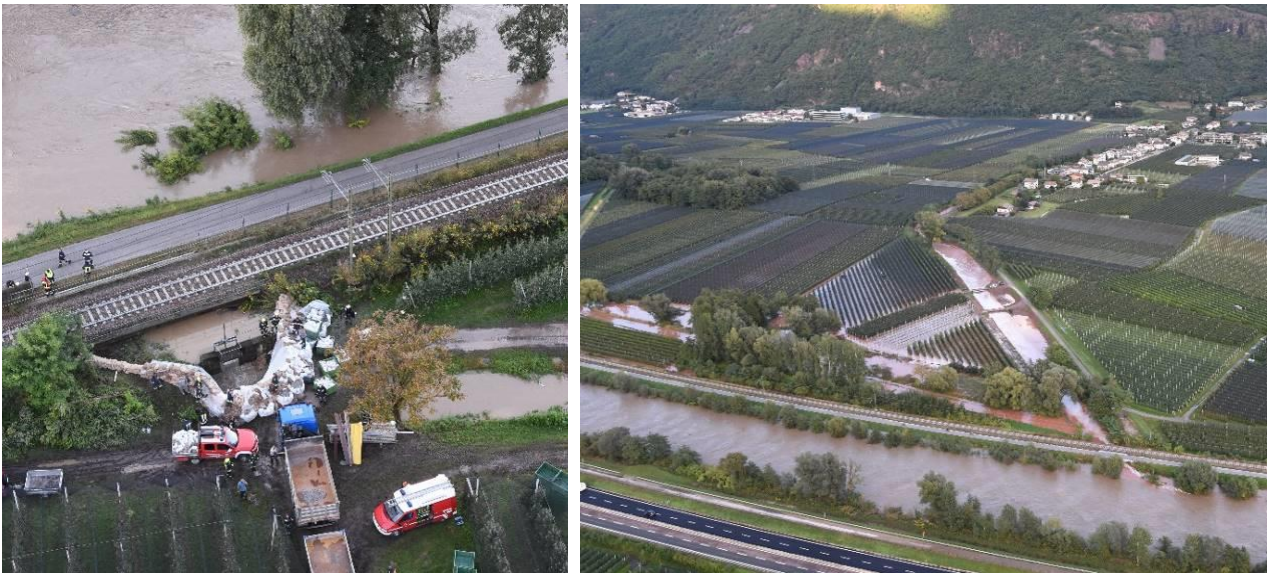
Abb. 14: links: Feuerwehreinsatz bei Schoberbrücke bei Siebeneich; rechts: Überschwemmung am Zusammenfluss von Etsch und Aschler Bach aufgrund des Rückstaus, bei dem die Etsch den Abfluss des Nebengerinnes wegen des Hochwassers nicht mehr aufnehmen konnte
