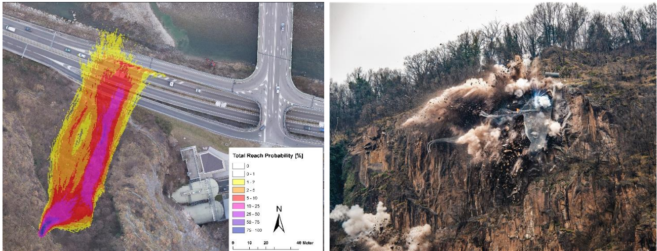
Abb. 36: Durchgeführte 3D-Steinschlagsimulationen, um die möglichen Trajektorien der Sturzblöcke und die Reichweite zu ermitteln bzw. um die entsprechenden organisatorischen sowie Vorbereitungen zu treffen. Rechts im Bild die Sprengung am 10. Februar 2020
