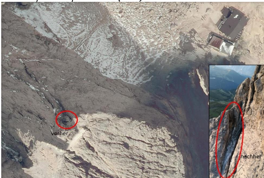
Figura 5.13: Crollo a valle della Punta Cinque Dita nel Gruppo del Sassolungo. Foto aerea della parete rocciosa interessata con l'area di distacco, il percorso di caduta e l'area di impatto alla base della parete (in alto a sx); foto dettagliata dell'area di impatto, che ha innescato ulteriori cadute di massi ai piedi del canale (in alto a dx); l'area sottostante la parete rocciosa interessata dalla caduta di blocchi, con il rifugio Toni Demetz sulla destra (sopra); Confronto prima e dopo il distacco (sotto). Il video della caduta massi è accessibile tramite codice QR
