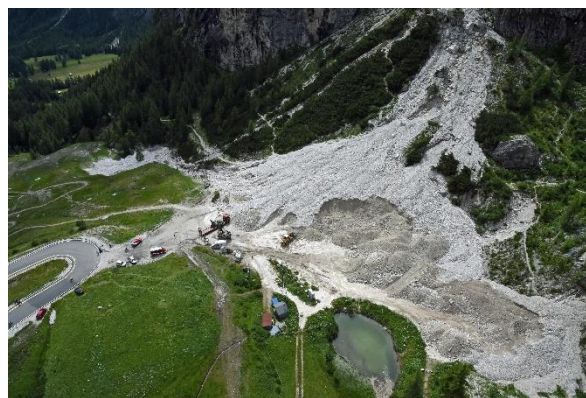
Figura 4.11: il parcheggio di accesso alla via ferrata Tridentina è stato ricavato a margine del conoide a valle della Val Setus. Il danno potenziale varia in funzione del livello di occupazione del parcheggio, soprattutto nel caso in cui sostino camper o caravan
