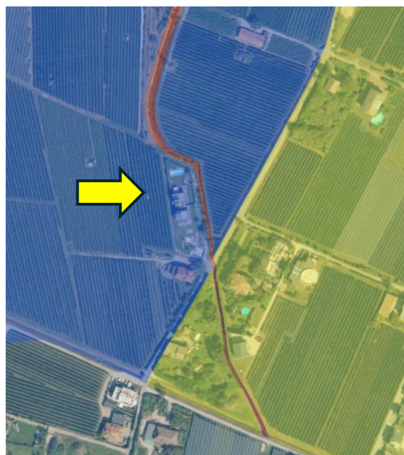
Figura 4.8: il fondovalle dell'Adige è caratterizzato da estese zone di pericolo medi ed elevato, spesso legate ad esondazioni frequenti, ma di bassa intensità, di fosse e piccoli torrenti. Queste situazioni possono essere gestite con interventi che facilitino il deflusso ma anche semplici interventi di riduzione della vulnerabilità.
