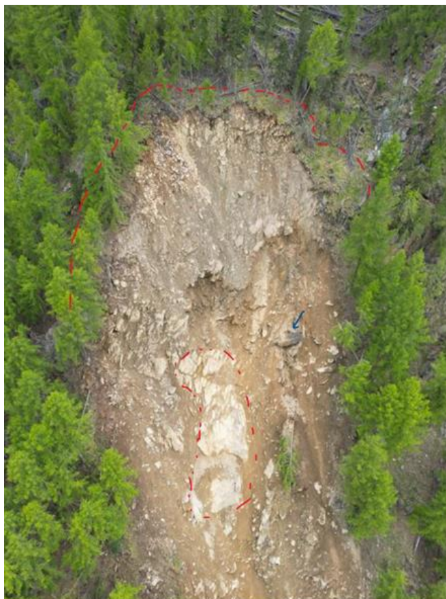
Figura 5.11: Nicchia di distacco del canalone “Glorgraben” con grande fessura centrale esposta in direzione ENE-OSO (a sinistra) e nicchia di distacco del canalone “Stallelegraben” e parete rocciosa fortemente disgregata (a destra).
