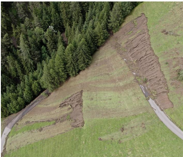
Figura 4.13: le precipitazioni intense hanno innescato diffuse frane superficiali sui prati ripidi le scarpate della strada verso Partinges. I detriti sono stati trasportati nel fossato Kirch, dove sono stati parzialmente intercettati dai muri di difesa recentemente realizzati dall'Ufficio Bacini montani Nord.
