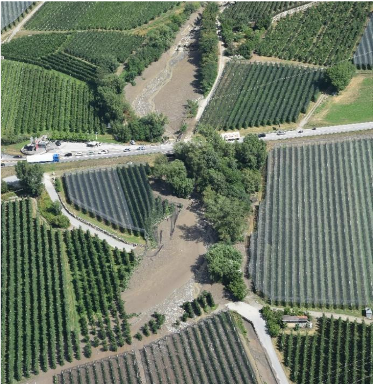
Figura 4.13: I danni nelle aree coltivate, seppur significativi, sono sicuramente inferiori ai danni che potrebbero verificarsi in aree insediative; ove non sia possibile contenere le portate negli alvei è quindi auspicabile prevedere una possibilità di sfogo in frutteti e campi, riducendo i potenziali danni mediante una corretta compartimentazione delle superfici
