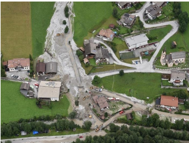
Abb. 4.14: Naturereignisse sind als Hauptmaßstab für Plausibilitätsprüfungen der Gefahrenzonenpläne heranzuziehen. In diesem Fall entsprechen die im Gefahrenzonenplan ausgewiesenen Gefahrenzonen des Kogbaches exakt jenem Ereignis, das sich am 5. August ereignet hat.
