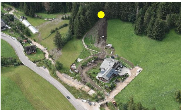
Abb. 4.18: Das Szenario der Verklauung der Brücke über die Forststraße (gelber Punkt) wurde in den Studien für den Gefahrenzonenplan der Gemeinde Enneberg (Foto rechts), der derzeit in Ausarbeitung ist, korrekt berücksichtigt, was die Wichtigkeit dieses Planungsinstruments hervorhebt.
