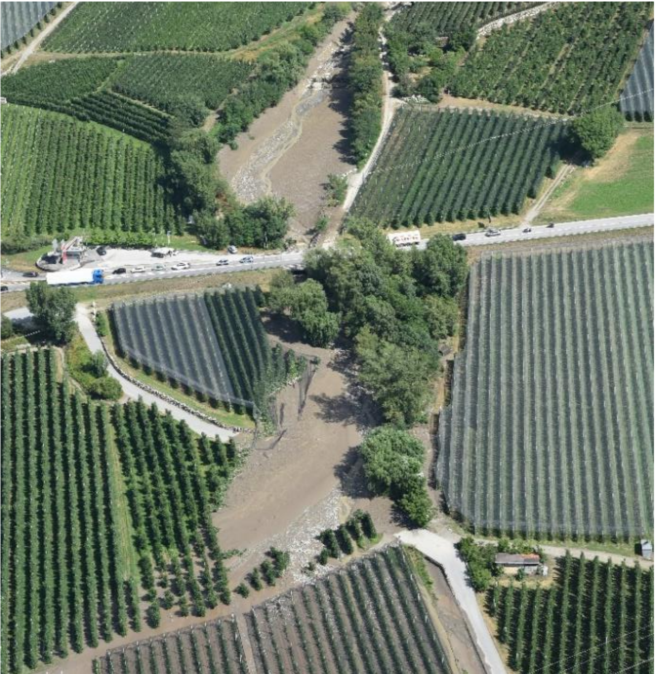
Abb 4.13: Die Schäden in den Obstplantagen sind zwar beträchtlich, jedoch fallen sie mit Sicherheit geringer aus als jene Schäden, die in Siedlungsgebieten auftreten könnten. An jenen Orten, wo eine Eindämmung der Abflussmengen in Gerinnen nicht möglich ist, wird die Schaffung eines Abflusses in Plantagen und Feldern empfohlen. Dies dient primär der Eindämmung von potenziellen Schäden durch die angemessene Einteilung des Nutzgebietes.
