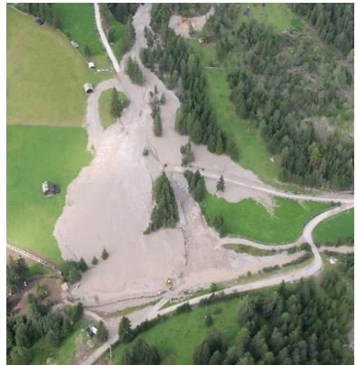
Abb. 4.16: Das Ereignis des Bronsarabaches führte etwa 45.000-60.000 m 3 Schutt flussabwärts. Dabei handelte es sich um ein deutlich größeres Volumen als bei den vorherigen Ereignissen (rechtes Bild: Aufnahme des Murganges von 2012).
