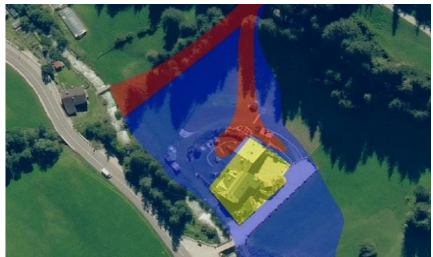
Abb. 4.18: Das Szenario der Verklauung der Brücke über die Forststraße (gelber Punkt) wurde in den Studien für den Gefahrenzonenplan der Gemeinde Enneberg (Foto rechts), der derzeit in Ausarbeitung ist, korrekt berücksichtigt, was die Wichtigkeit dieses Planungsinstruments hervorhebt.
