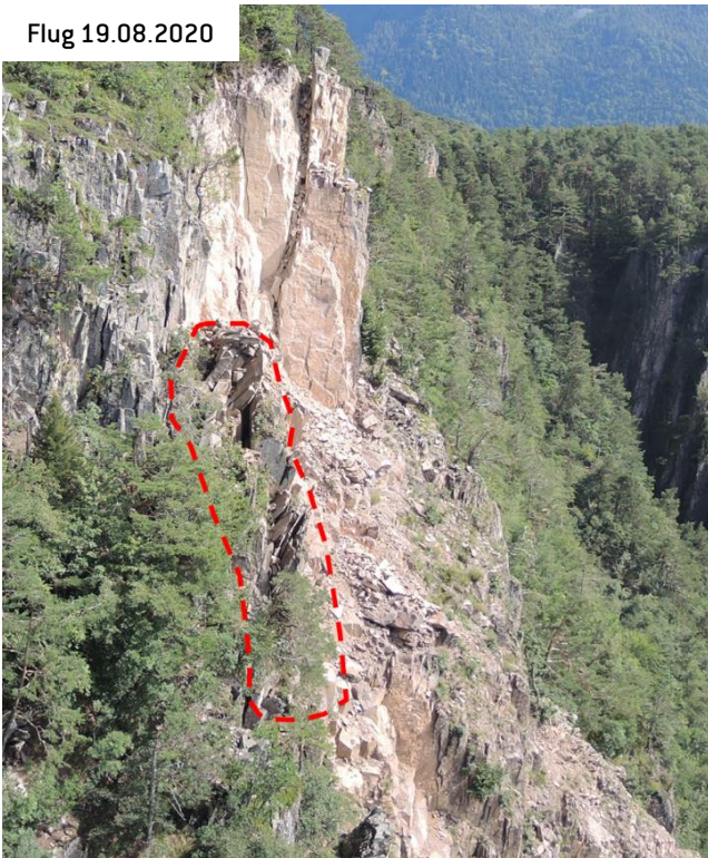
Abb. 5.9: Fotovergleich der Abbruchnischen des Felssturzes 2018 und 2022, anhand unterschiedlicher Flugaufnahmen. Sowohl in der Frontal- als auch in der Lateralansicht kann man das Abbruchvolumen vom 15. Jänner 2022 sehr gut eingrenzen.
