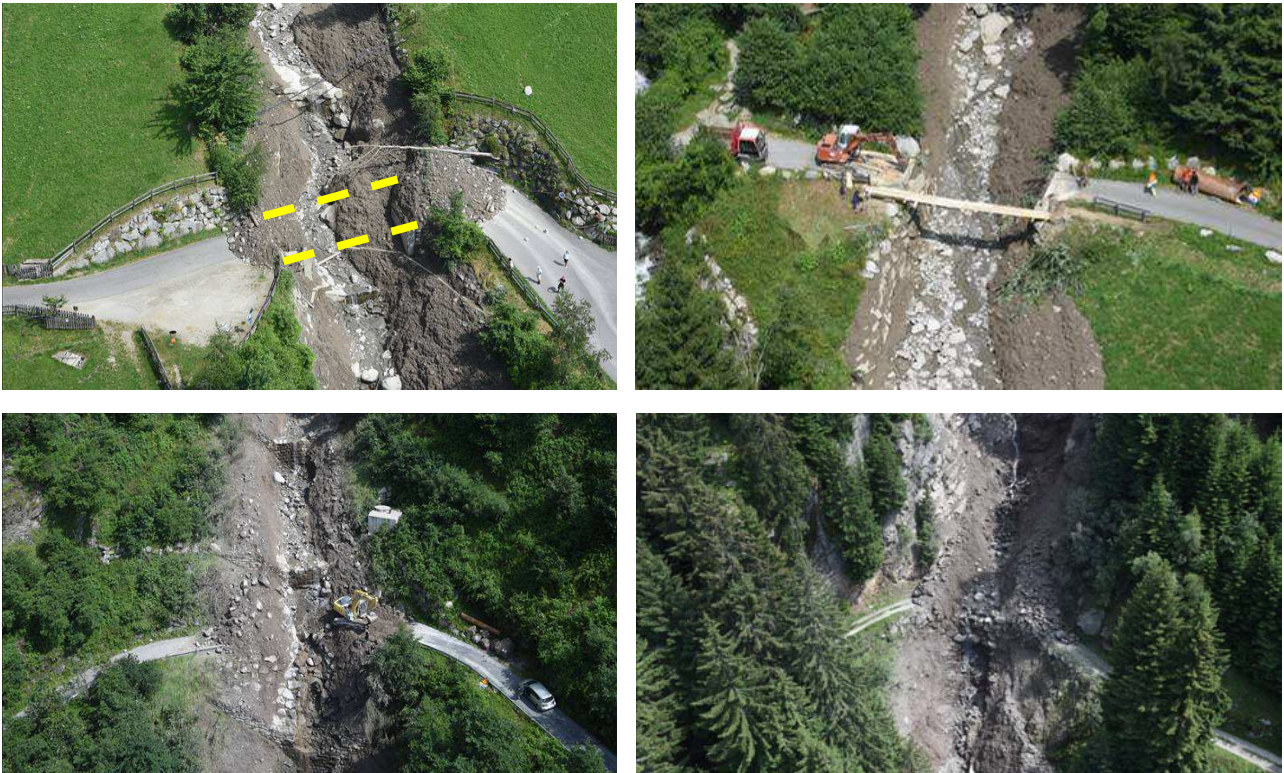
Abbildung 5: Der Höllentalbach hat ein sehr großes Geschiebepotential im oberen Einzugsgebiet. Das mobilisierte Geschiebe durchpflügt den Graben im steilen Hang und bewirkt schwere Schäden an den Bachquerungen
