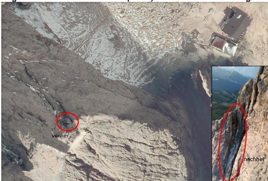
Abb. 5.13: Blockschlag unterhalb der Fünffingerspitze in der Langkofelgruppe. Luftbildaufnahme der betroffenen Felswand mit Abbruchbereich, Sturzbahn und Aufschlagbereich an der Basis der Felswand (oben links); Detailfoto des Aufschlagbereichs, welcher weitere Steinschläge am Fuße des Kanals ausgelöst hat (oben rechts); der vom Blockschlag betroffene Bereich unterhalb der Felswand, rechts im Bild die Toni Demetz Hütte (oben); Vergleich vor und nach dem Abbruch (unten). Das Video vom Blockschlag ist mittels QR-Code abrufbar.
