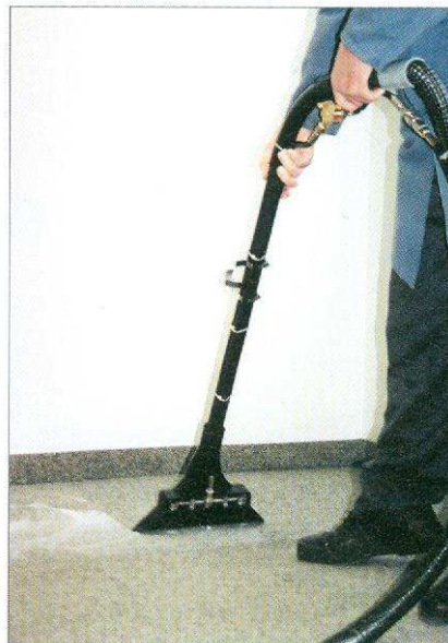
Durchspülen des Flors und Absaugen des Schaums mit dem Sprühextraktionsgerät
