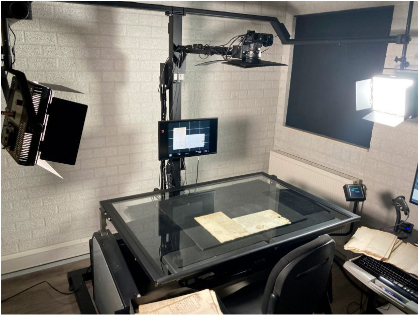
Opstelling van apparatuur om archieven te digitaliseren, hier voor het archief van het Hof van Friesland, in Hurdegaryp.
