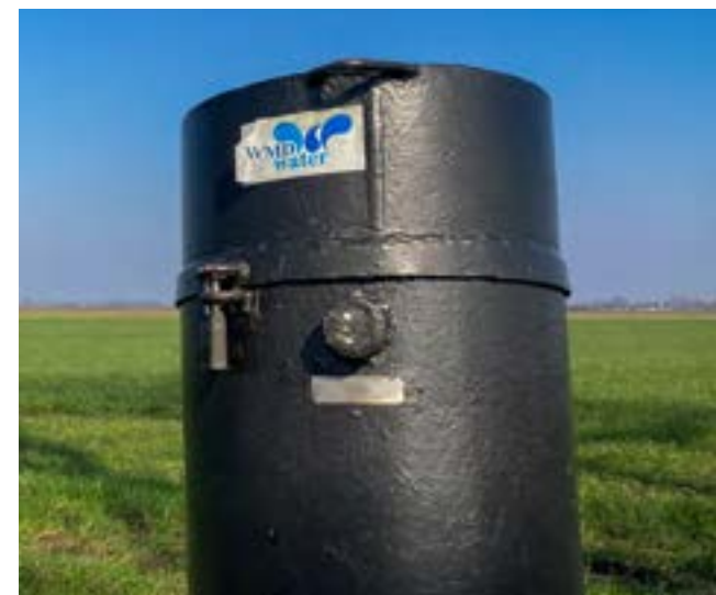
Foto: Monitoringsput voor grondwater, van WMD
