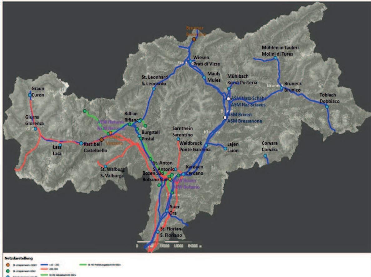
Abb. 6: Überblick über das bestehende Hochspannungsnetz in Südtirol (Stand 2015) (Quelle: EDYNA). Die blauen Linien stellen die 132 kV-, die Roten die 220 kV- und die Grünen die 66 kV-Leitungen dar.
