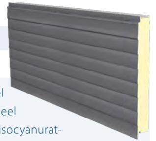
JI Sidings 1000VB PIR ist ein isoliertes Paneel mit verdeckter Befestigung. Das Paneel kann sowohl als Dach als auch als Wand verwendet werden. Das Sandwichpaneel besteht aus einem äußeren Stahlblech mit Plankenmuster, einem Kern aus Polyisocyanurat-Schaum (PIR) ohne schädliche FCKW-HCKW-Verbindungen und einer leicht linierte Innenplatte. Kurzum, die Gesamtlösung für Ihre Projekte im Dienstleistungs- und Wohnbereich mit einer hochwertigen Verarbeitung.
