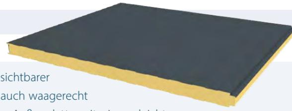
Jl Wall PIR 40-60 mm (LL) ist ein isoliertes Paneel mit sichtbarer Montage. Dieses Wandpaneel kann sowohl senkrecht als auch waagrecht montiert werden. Das Sandwichpaneel besteht aus einer Außenplatte mit einem leicht linierten Profil, einem Kern aus Polyisocyanurat-Schaum (PIR) ohne schädliche FCKW-HCKW-Verbindungen und einer leicht linierten Innenplatte. Diese Innen- oder Außenwände sind eine geeignete Lösung für Ihre Projekte im landwirtschaftlichen, industriellen und Dienstleistungssektor.
