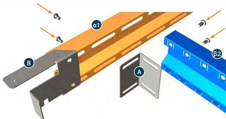
Ajuster les profils  $\beta$  selon la largeur de l'ouverture. Fixation des profils  $\beta$  avec les équerres **B** sur les profil  $\alpha$  au dimensions désirée.
