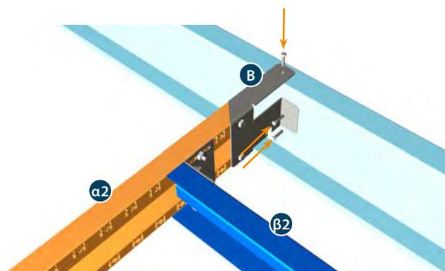
Le chevêtre monté se pose sur les pannes. Fixation avec 3 vis autotauradeuses par appui.
