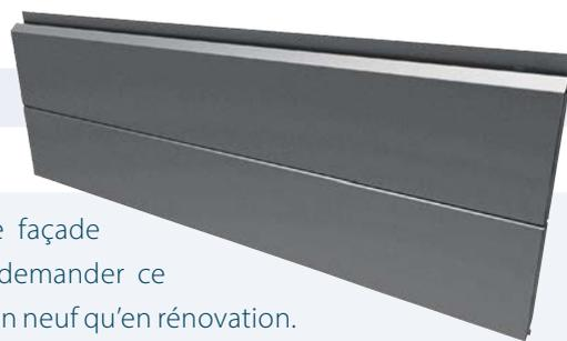
La lame Jl Grégale R300 rainurée est un système d'habillage de façade rapportée, d'aspect plan, à fixations cachées. Il est possible de demander ce produit avec les ergots (option sur demande). Elle s'utilise aussi bien en neuf qu'en rénovation. Cette lame rainurée ('effet trompe l'œil') se pose de bas en haut. Ce produit nécessite un support réglé ou une ossature réglable.
