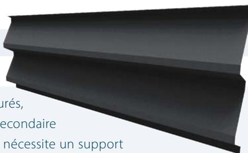
Les profils JI Brevia 66 sont des profils d'habillage de façade nervurés, « type clins ». La pose se fait en fixation apparente, sur une ossature secondaire rapportée et adaptée au support (plateau, maçonnerie...). Ce produit nécessite un support réglé ou une ossature réglable. Ces profils fluides et allongés peuvent être posés indifféremment en vertical ou à l'horizontale. La mise en œuvre se fait par principe de recouvrement.
