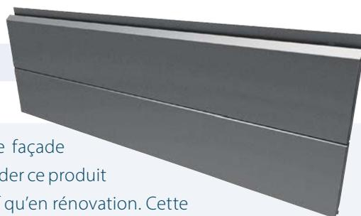
La lame Jl Grégale bordée rainurée est un système d'habillage de façade rapportée, d'aspect plan, à fixations cachées. Il est possible de demander ce produit avec les ergots (option sur demande). Elle s'utilise aussi bien en neuf qu'en rénovation. Cette lame bordée et rainurée ('effet trompe l'œil') se pose de bas en haut. Ce produit nécessite un support réglé ou une ossature réglable.
