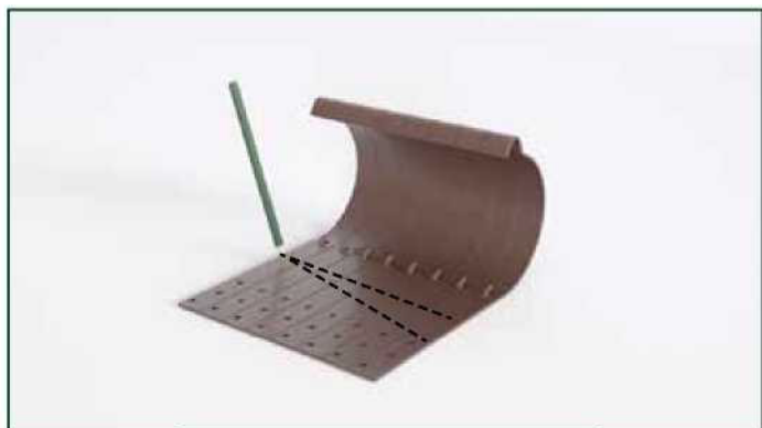
Маркиране на зоната на огъване
