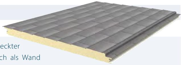
JI Slate 1000VB PIR ist ein isoliertes Paneel mit verdeckter Befestigung. Das Paneel kann sowohl als Dach als auch als Wand verwendet werden. Das Sandwichpaneel besteht aus einem äußeren Stahlblech mit Schiefermuster, einem Kern aus Polyisocyanurat-Schaum (PIR) ohne schädliche FCKW-HCKW-Verbindungen und einer leicht linierte Innenplatte. Kurzum, die Gesamtlösung für Ihre Projekte im Dienstleistungs- und Wohnbereich mit einer hochwertigen Verarbeitung.
