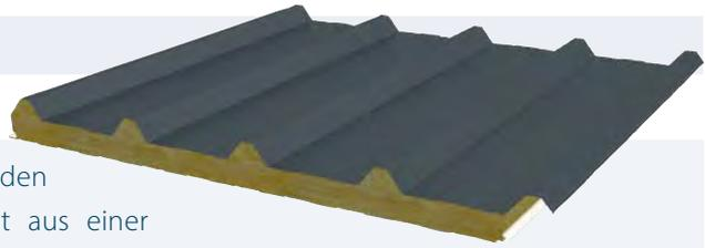
JI Vulcasteel Roof ist ein isoliertes Dachpaneel für den Bau von Schrägdächern. Das Sandwichpaneel besteht aus einer trapezförmigen Außenplatte, einem Steinwollkern und einer leicht linierten Innenplatte. Durch die Dicke von bis zu 200 mm kann ein hohe Feuerbeständigkeit und Lärminderung erreicht werden. Kurz gesagt, die Lösung für Ihre Projekte in der Landwirtschaft, der Industrie, im Dienstleistungssektor und sogar im Wohnbereich mit Anforderungen an Schallabsorption und Feuerbeständigkeit.
