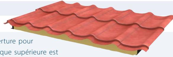
Le Jl Permapan PIR est un panneau sandwich de couverture pour les constructions neuves ainsi que la rénovation. La plaque supérieure est emboutie au motif des tuiles. Reçoit en sous face une isolation thermique en mousse de polyisocyanurate (PIR). La laque définie à la commande du Jl Permapan PIR est appliquée en face A.
