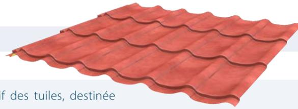
La tuile 24-183-1100 est une plaque emboutie au motif des tuiles, destinée aux couvertures sèches et surcouvertures de pente courante 25% à 50%. Elle est une alternative aux tuiles classiques pour les nouvelles constructions, mais peut aussi servir pour la rénovation de vieilles toitures. La laque définie à la commande de Jl 24-183-1100 Panneau-tuile est appliquée en face SO. Nous consulter à la commande pour connaissance de la méthode de calepinage.
