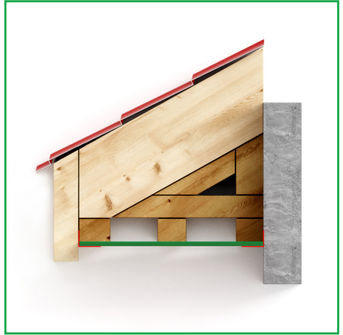
Distanța între reazeme cu structură complexă > 400mm
