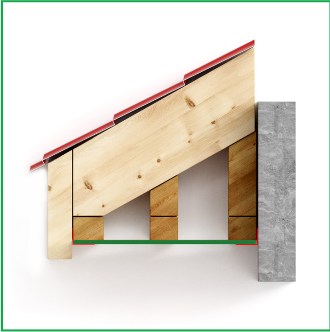
Distanța între reazeme cu structură simplă > 400mm
