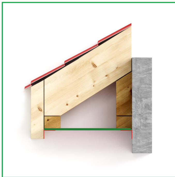
Distanța între reazeme \leq 400\text{mm}
