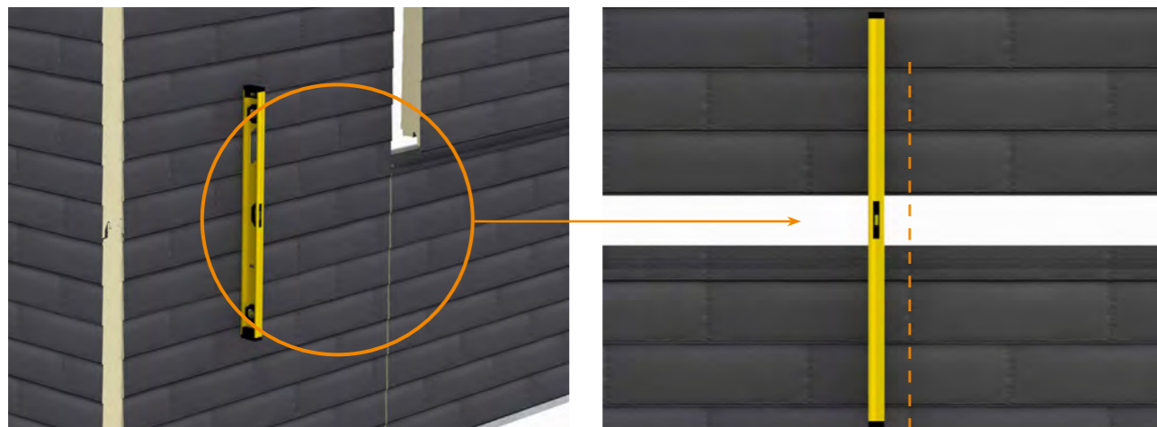
Contrôle du niveau et de l'aplomb
