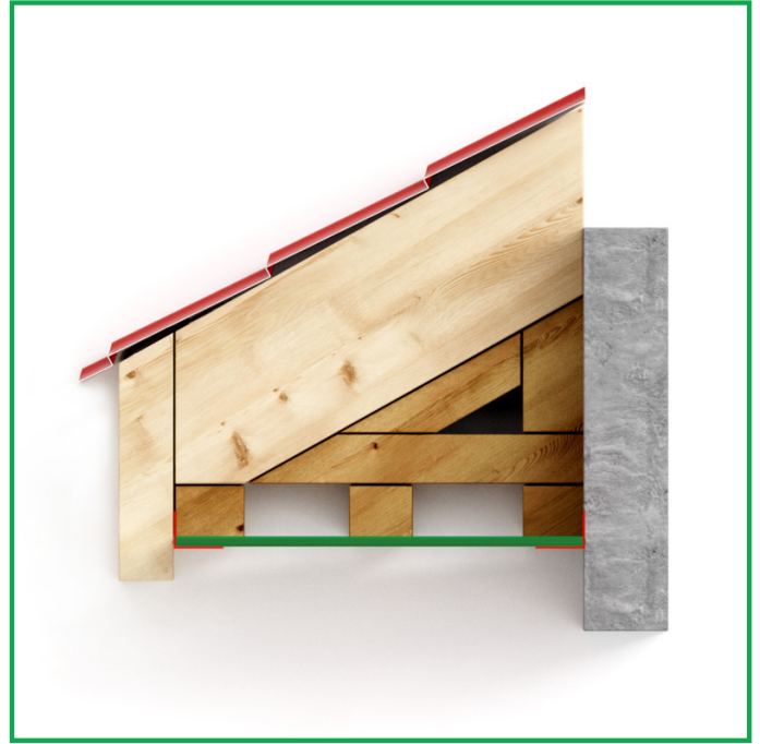
Distanța între reazeme cu structură complexă > 400mm
